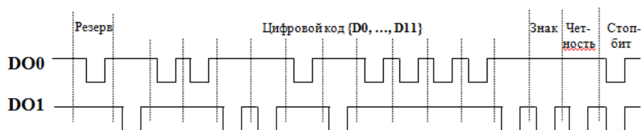
Рисунок 1. Протокол передачи по последовательному каналу для 1583HA015
