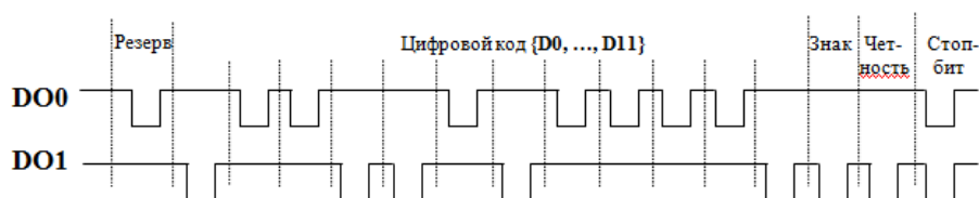
Рисунок 1. Протокол передачи по последовательному каналу для 1586ПА1У
