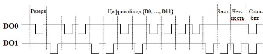
Рисунок 1. Протокол передачи по последовательному каналу для 1586ПВ1У
