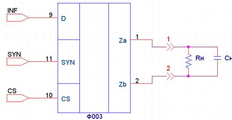
рис.2. Схема включения микросборок Ф003, Ф003.2
