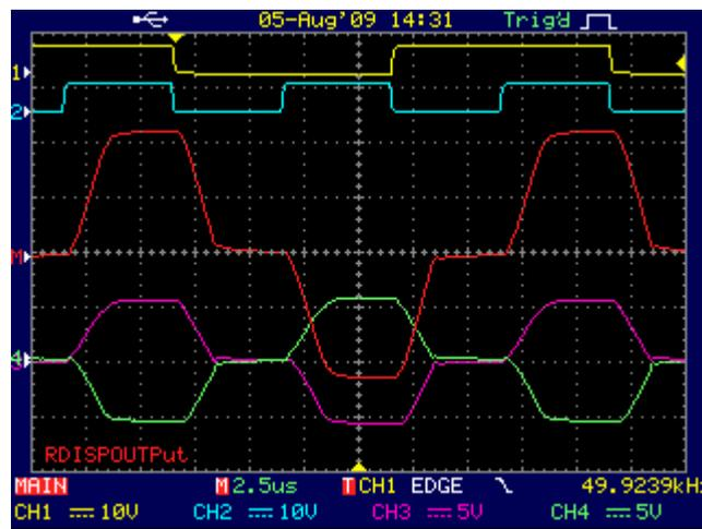
рис. 10. Ф003,  $R_H=600 \text{ Ом}$ ,  $C_H=4.7\text{нФ}$
