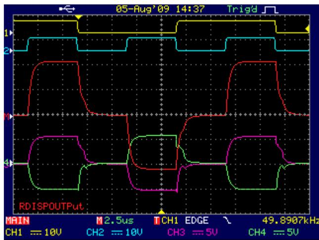
рис. 9. АП003,  $R_H=600 \text{ Ом}$ ,  $C_1=4.7\text{нФ}$
