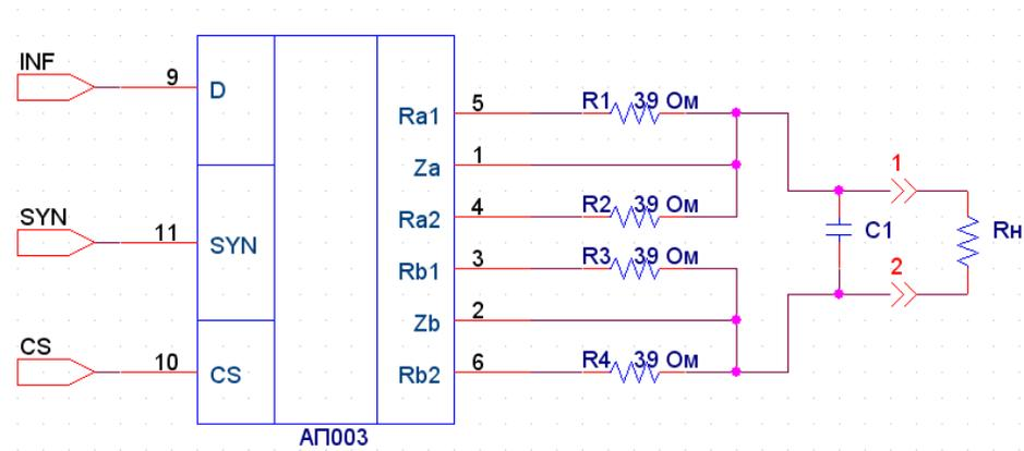
рис.1. Схема включения микросборки АР003
