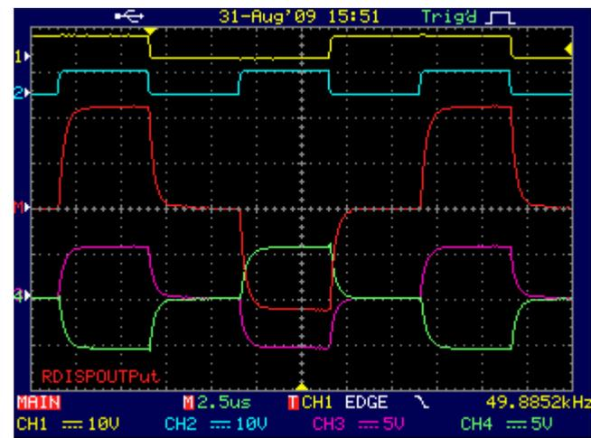
рис. 11. Ф003.2,  $R_H=600 \text{ Ом}$ ,  $C_H=4.7\text{нФ}$
