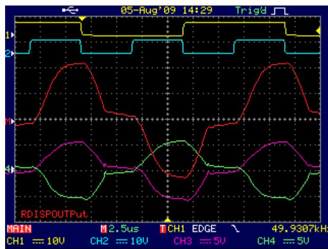
рис. 13. Ф003,  $R_H=600 \text{ Ом}$ ,  $C_H=10\text{нФ}$
