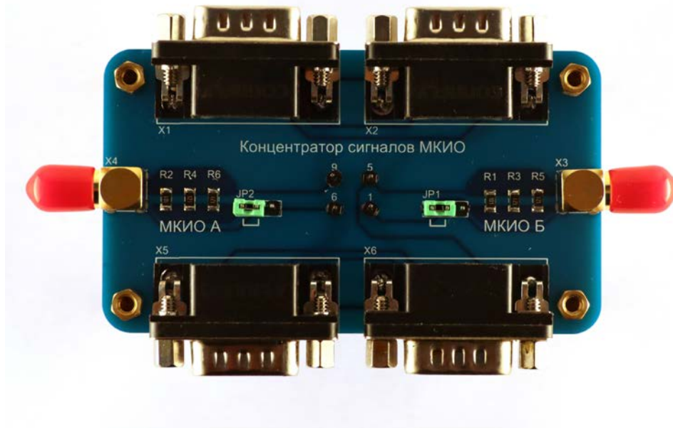
Рисунок 3. Плата «Концентратор сигналов МКИО»
