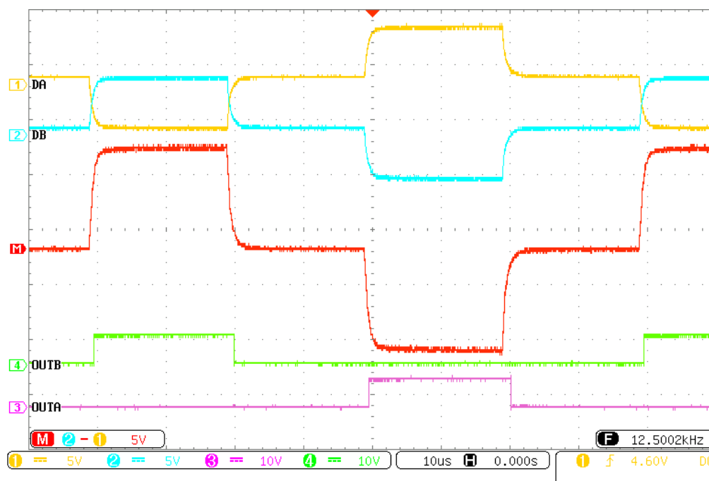
Рисунок 6. Осциллограмма работы приёмника на частоте 12.5кГц
