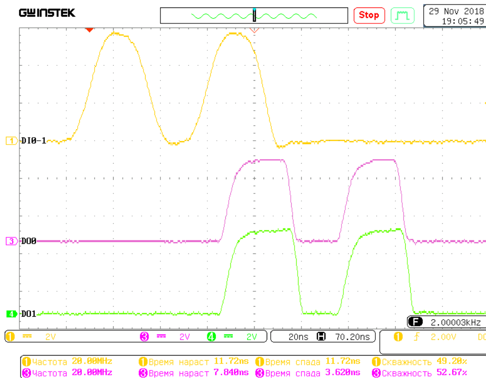
Рисунок 9. Осциллограмма передачи двух положительных импульсов
