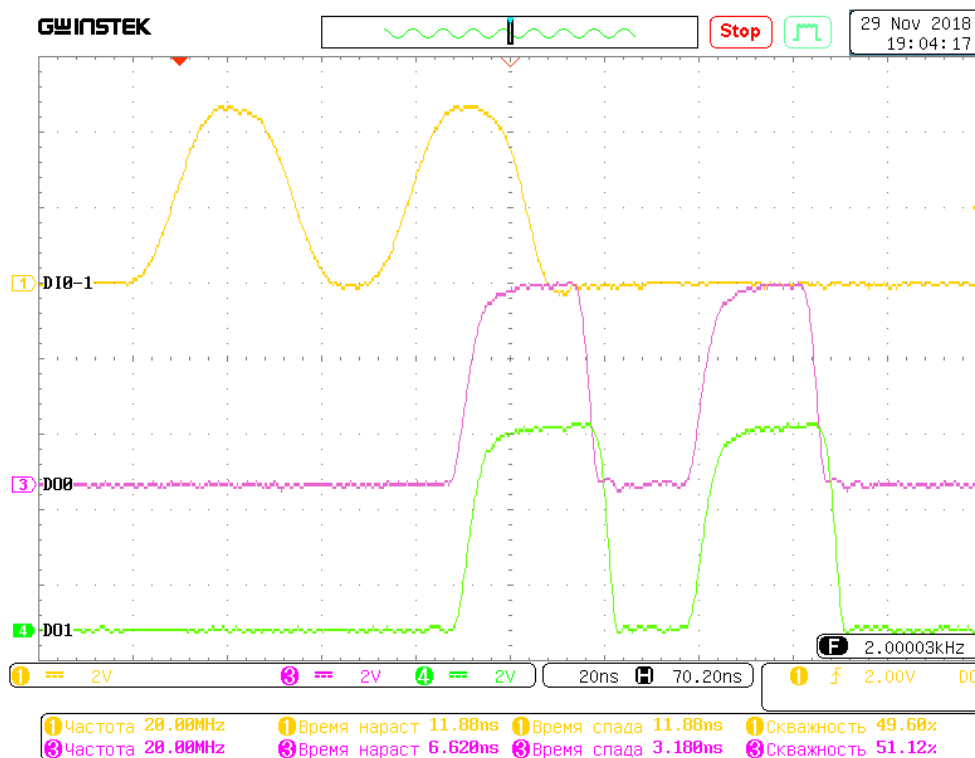
Рисунок 8. Осциллограмма передачи двух положительных импульсов
