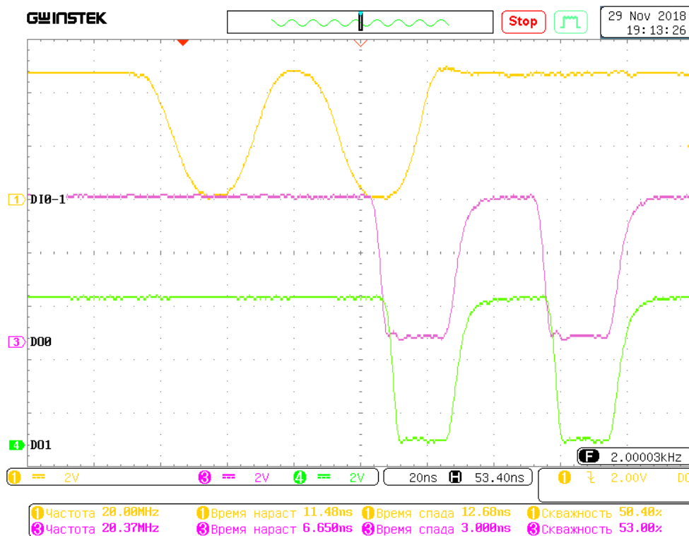
Рисунок 11. Осциллограмма передачи двух отрицательных импульсов
