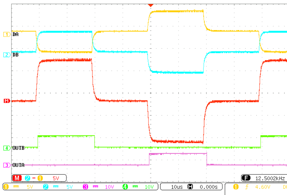
Рисунок 6. Осциллограмма работы приёмника на частоте 12.5кГц
