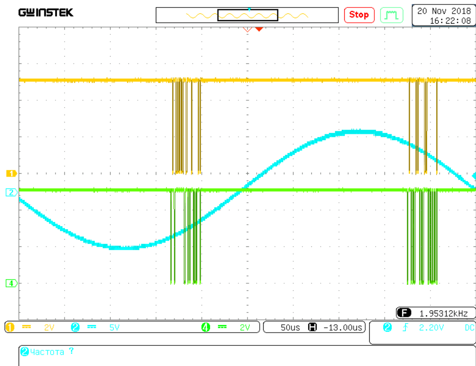
Р и с у н о к 2.3 – Осциллограмма работы по сигналу F МСБ 2015НХ01В1, 2015НХ01В4
