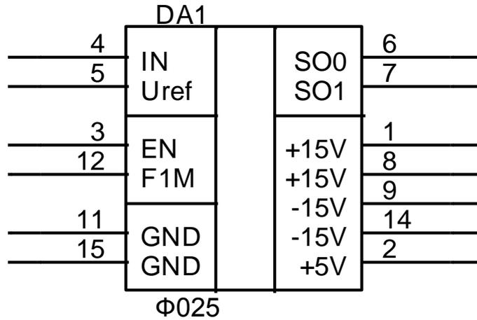
Схема включения Φ025 с микросхемой H1582ВЖ3В-0271
