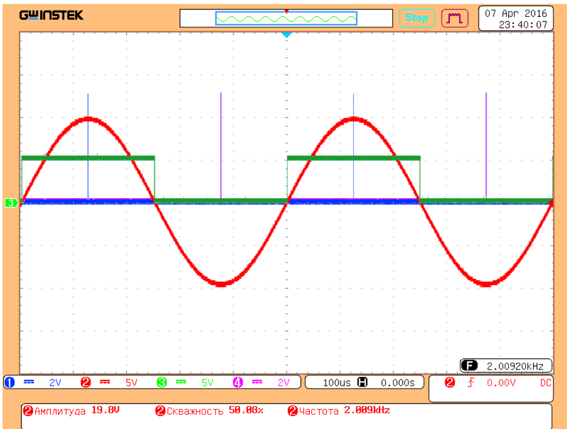
Рисунок 3. Осциллограмма выходных сигналов OUT1, Comp, Amp_P, Amp_N микросборки 2015MM024(025) при подаче на вход Rext отрицательного напряжения
