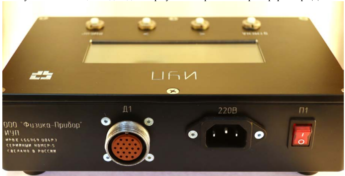
Р и с у н о к 1 – Общий вид индикатора угла поворота вала трансформатора ДБСКТ
